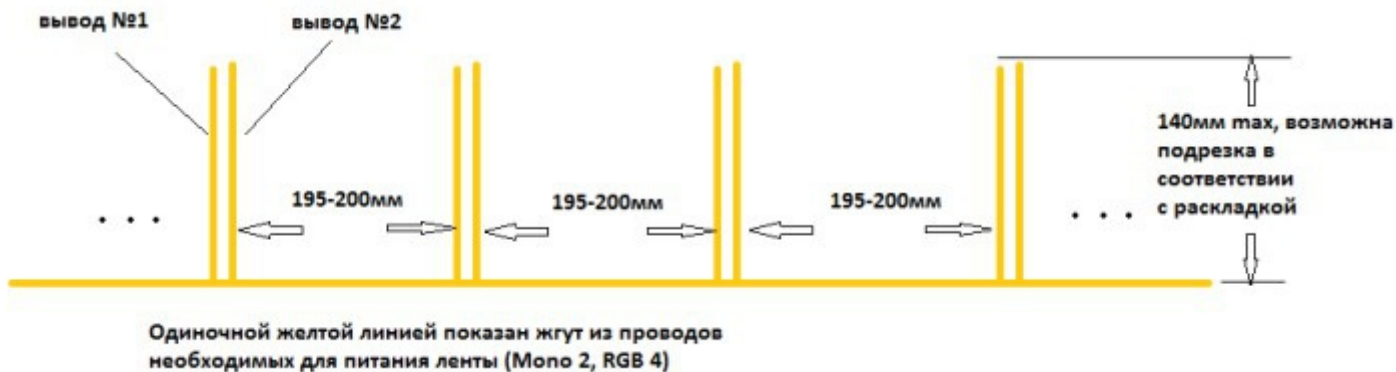
Рис 9. Конструкция подводящего провода
