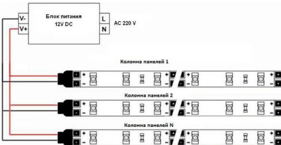
Рис. 8 Подключение колонн панелей к блоку питания
